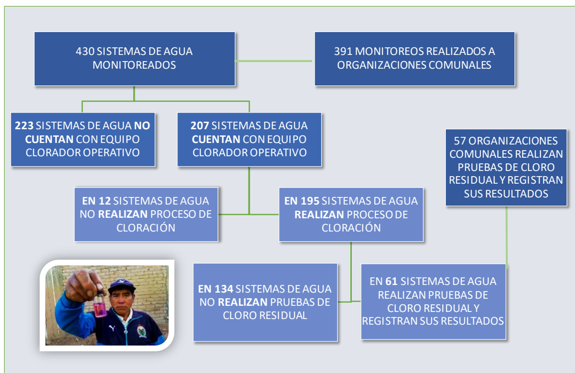
Figura N° 5: Proceso de cloración que realizan las organizaciones comunales
